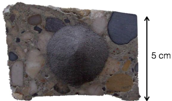
Figure 5-77 : Vue de dessus d'une éprouvette en béton avec l'acier 304L.
