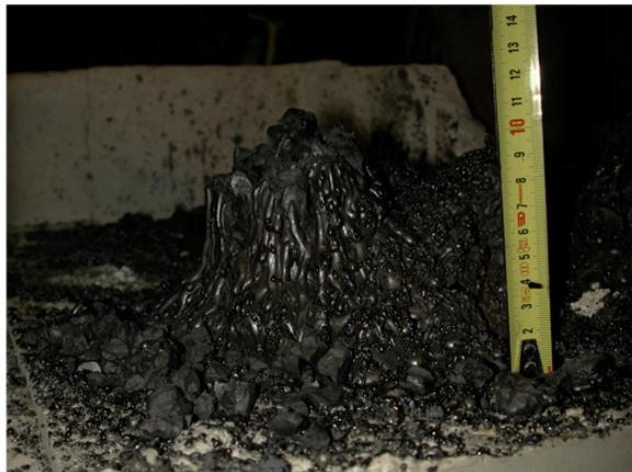
Figure 4-4 : Cône volcanique à la surface du corium.
