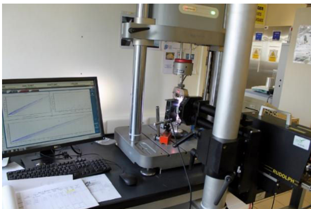
Figure 3.9 : Machine utilisée pour les essais mécaniques et conditions limites des éprouvettes longitudinales et transversales.
