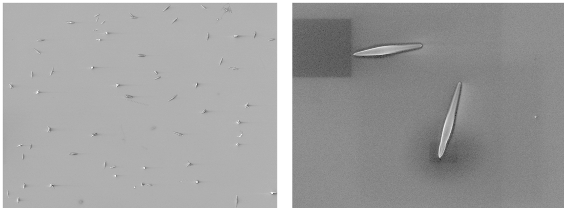
Figure III-11 : Nitrure de titane post attaque HF vapeur. La réaction de l'acide fluorhydrique avec le TiN a généré des structures visibles sur l'image de droite.
