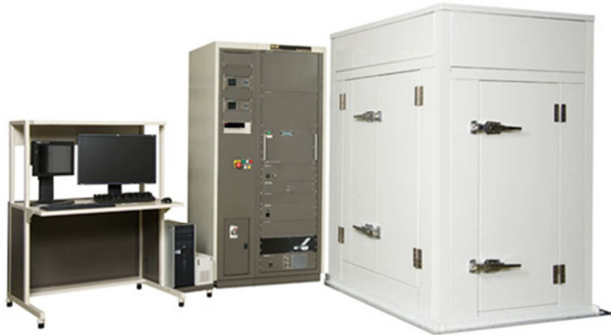
Figure II-34 : Phi 700Xi, composé d'un ordinateur de commande, d'une baie électronique et d'une chambre acoustique enfermant le bâti d'analyse.
