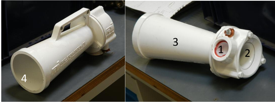
Figure 134 : Représentation d'une buse d'éjection avec ses 4 parties distinctes : 1 : entrée primaire, 2 : entrée secondaire, 3 : extérieur du tube divergent et 4 : sortie de buse. (Source : INERIS, rapport d'étude, 2014)
