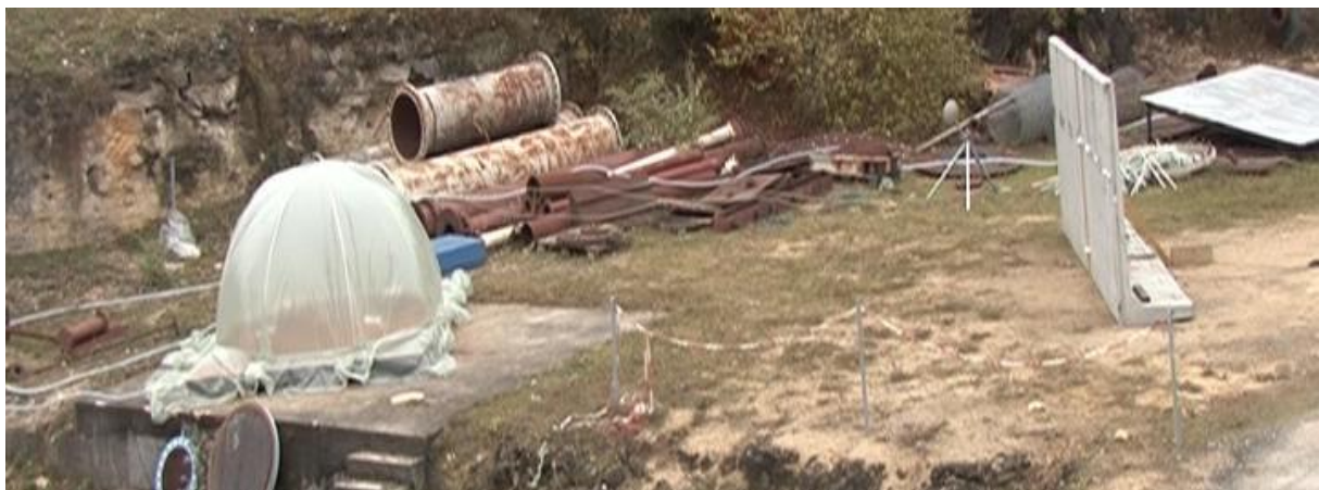
Figure 136 : Mur de protection positionné à 10 m du centre de la structure hémisphérique.
