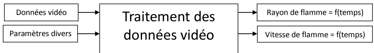
Figure 142 : Diagramme entrée sortie du programme de traitement vidéo.
