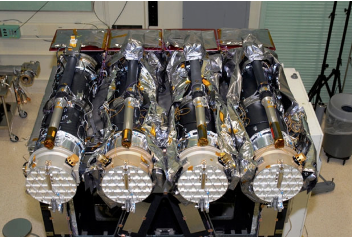
FIGURE 4.2 – Les quatre télescopes AIA sur le banc de montage avant leur mise en place sur le satellite SDO dans la salle blanche du Goddard Space Flight Center à la NASA. Chaque télescope possède un miroir primaire de 20 cm. Grâce à un système de filtres en longueurs d'onde et de roues, chaque télescope peut observer la couronne dans deux bandes de longueurs d'ondes. Source : Lemen et al. (2012) .
