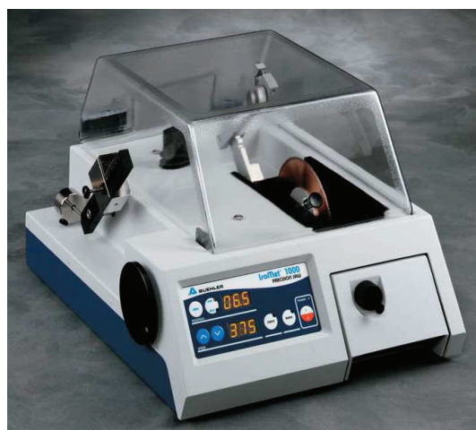
Figure 2 - 3 : Appareil de découpe du graphite (IsoMet 1000, Buehler®).
