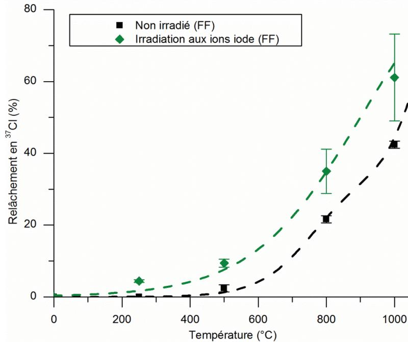
Figure 3 - 21 : Comparaison du relâchement en  $^{37}\text{Cl}$  pour des échantillons (FF) non irradiés (traitement thermique 8 h) et irradiés avec un faisceau d'ions iode en fonction de la température. Les courbes en pointillés permettent de guider l'œil.
