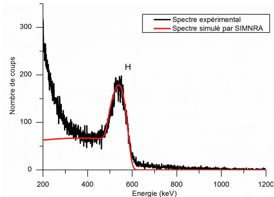
Figure 5 - 28 : Spectres ERDA expérimental et simulé avec SIMNRA du dépôt carboxyhydrogéné (Energie  $\text{He}^+$  = 1,7 MeV,  $\theta = 30^\circ$ , épaisseur de l'écran de Mylar =  $6,5 \mu\text{m}$ ).
