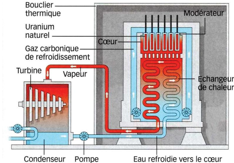
Figure 1 - 7 : Schéma de fonctionnement d'un réacteur UNGG.
