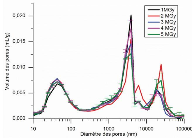
Figure 4 - 26 : Evolution de la distribution du diamètre des pores en relation avec le volume de la porosité (porosimétrie mercure) en fonction de la dose déposée.
