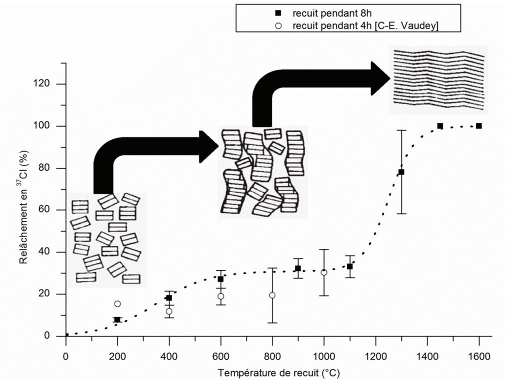
Figure 2 - 38 : Evolution du pourcentage de relâchement en  $^{37}\text{Cl}$  en fonction de la température du traitement thermique pour des recuits de 4 h et 8 h et pour des échantillons (fF) [Rouzaud 1983; Vaudey 2010]. La courbe en pointillé permet de guider l'œil.
