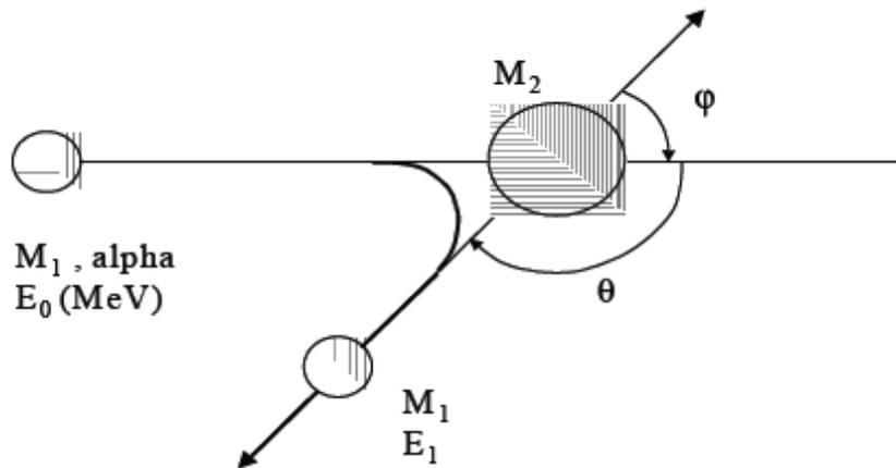
Figure 6 : Représentation schématique de la diffusion élastique.
