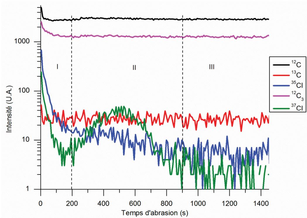
Figure 2 - 14 : Acquisition par SIMS, avec une source  $\text{O}_2$ , des signaux de  $^{12}\text{C}$ ,  $^{13}\text{C}$ ,  $^{12}\text{C}_3$ ,  $^{35}\text{Cl}$  et  $^{37}\text{Cl}$  sur un échantillon de graphite.
