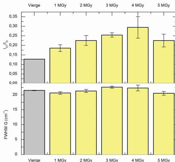
Figure 4 - 29 : Rapport  $I_{D1}/I_G$  et largeur à mi-hauteur de la bande G pour des échantillons non implantés issus de l'empilement de Saint-Laurent A2 irradiés par des photons gamma avec une dose déposée comprise entre 1 MGy et 5 MGy. Les barres d'erreurs représentent les incertitudes associées.
