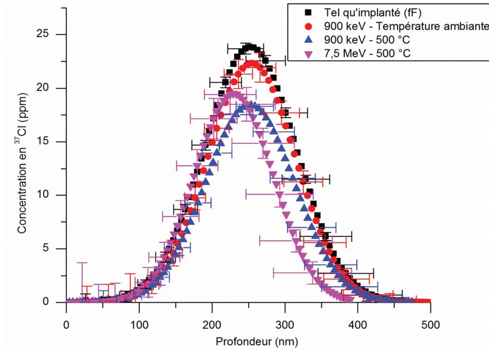
Figure 3 - 9 : Profils moyens de concentration en  $^{37}\text{Cl}$ , obtenus par TOF-SIMS, pour des échantillons de graphite nucléaire issus de l'empilement de Saint-Laurent A2 tel qu'implanté (fF) et irradiés à température ambiante et à 500 °C avec des faisceaux d'ions hélium d'énergie respective 900 keV et 7,5 MeV.
