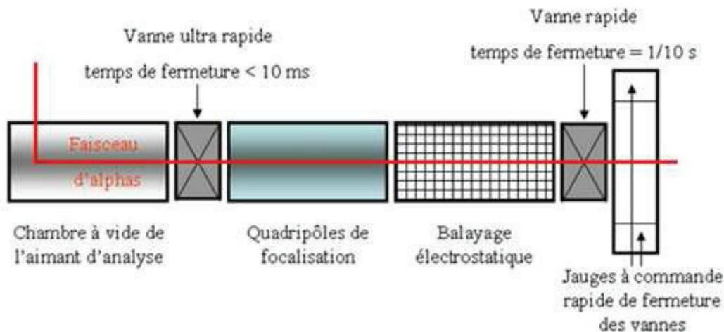
Figure 3 - 4 : Schéma de la voie de faisceau extrait de l'accélérateur Van de Graaff de l'IPNL.
