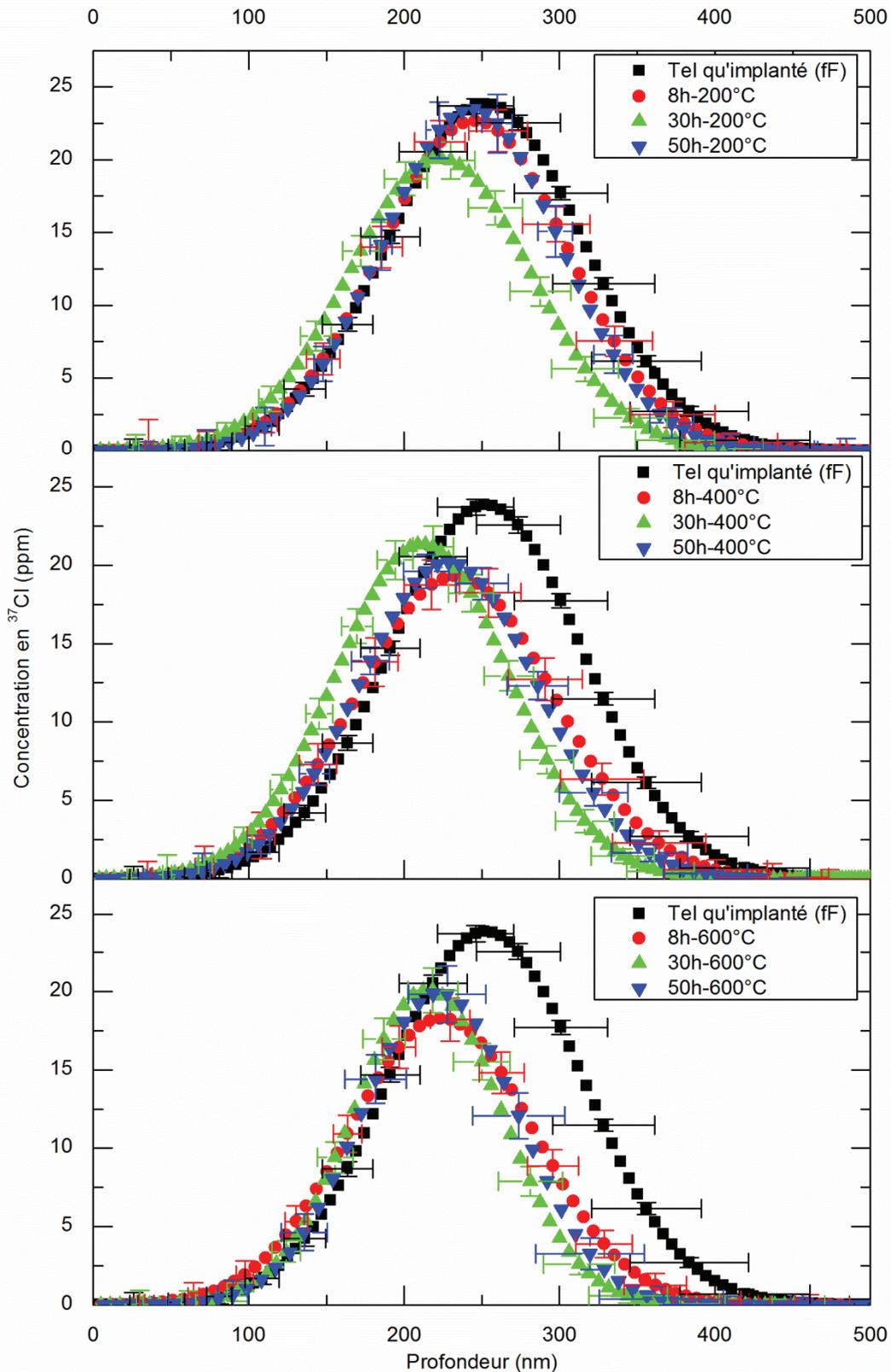
Figure 2 - 22 : Profils moyens de concentration en  $^{37}\text{Cl}$ , obtenus par TOF-SIMS, sur des échantillons de graphite nucléaire issus de l'empilement de Saint-Laurent A2 tel qu'implanté (fF) et recuits à 200 °C, 400 °C et 600 °C pendant 8 h, 30 h et 50 h.
