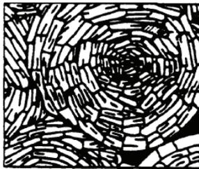
Figure 1 - 12 : Microstructures du coke isotrope
