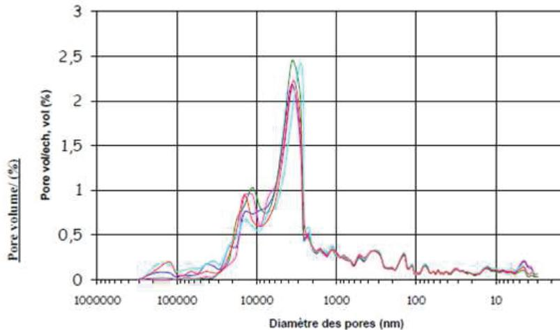
Figure 1 - 18 : Distribution du diamètre des pores en relation avec le volume de la porosité pour 5 échantillons d'empilement de G2 vierge similaires [Petit 2011].
