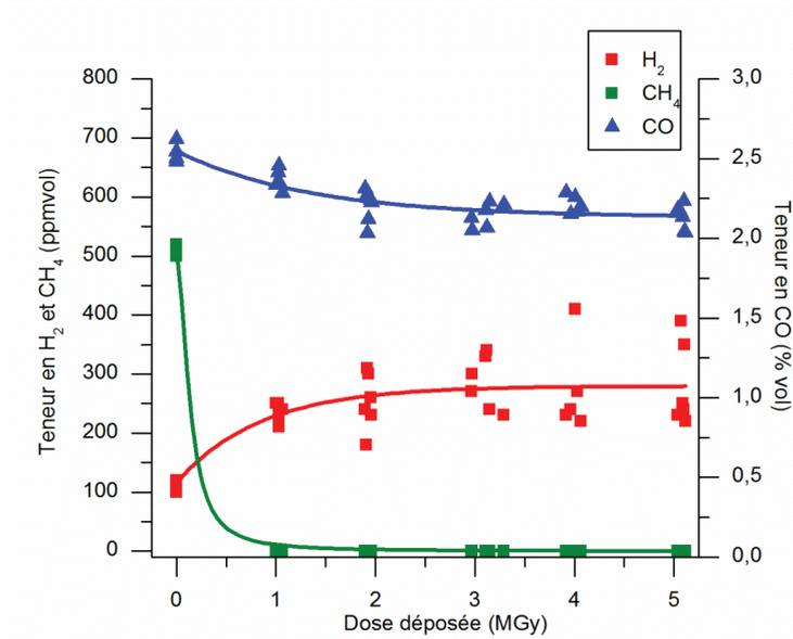
Figure 4 - 20 : Evolution des concentrations en H<sub>2</sub>, CH<sub>4</sub> et CO en fonction de la dose déposée.
