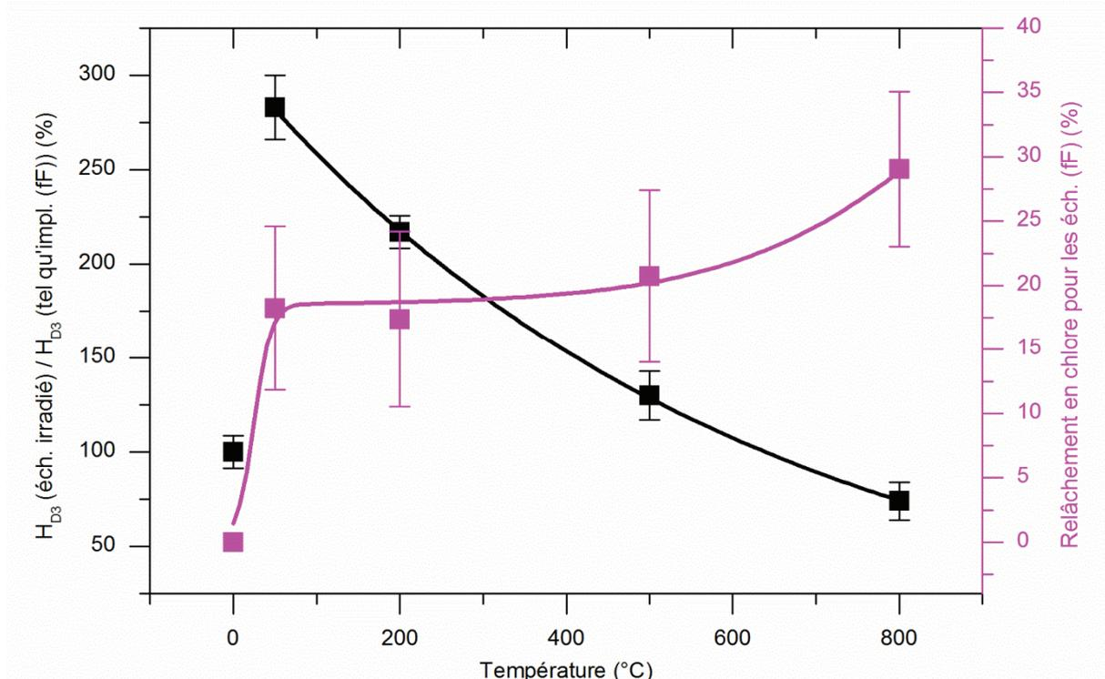
Figure 3 - 27 : Evolution de la hauteur de la bande  $D_3$  et du relâchement en fonction de la température d'irradiation pour des échantillons (FF). Les courbes en très plein permettent de guider l'œil.
