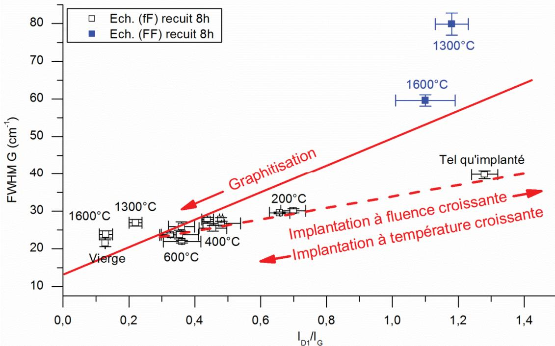
Figure 2 - 37 : Evolution de la largeur à mi-hauteur de la bande G en fonction du rapport des intensités des bandes D<sub>1</sub> et G pour des échantillons (fF) (en noir) et (FF) (en bleu) recuits pendant 8 h. Les droites rouges en trait plein et en tireté proviennent des travaux de M.R. Ammar et al. [Ammar 2013].
