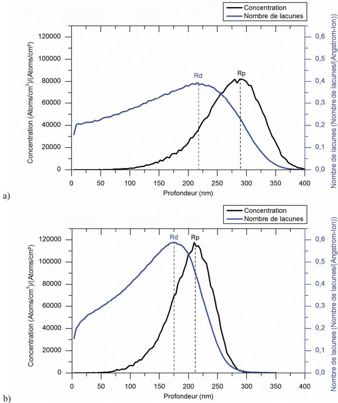
Figure 2 - 6 : Simulation par SRIM 2010 [Ziegler 1985] du profil de  $^{37}\text{Cl}$  implanté et du profil de déplacements par atome induit par l'implantation (250 keV) dans une matrice de carbone de masse volumique égale à : (a)  $1,68 \text{ g.cm}^{-3}$ . (b)  $2,27 \text{ g.cm}^{-3}$ .
