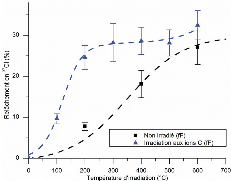
Figure 3 - 35 : Comparaison du relâchement en  $^{37}\text{Cl}$  pour des échantillons (fF) non irradiés (traitement thermique 8 h) et irradiés avec un faisceau d'ions carbone en fonction de la température. Les courbes en pointillés permettent de guider l'œil.
