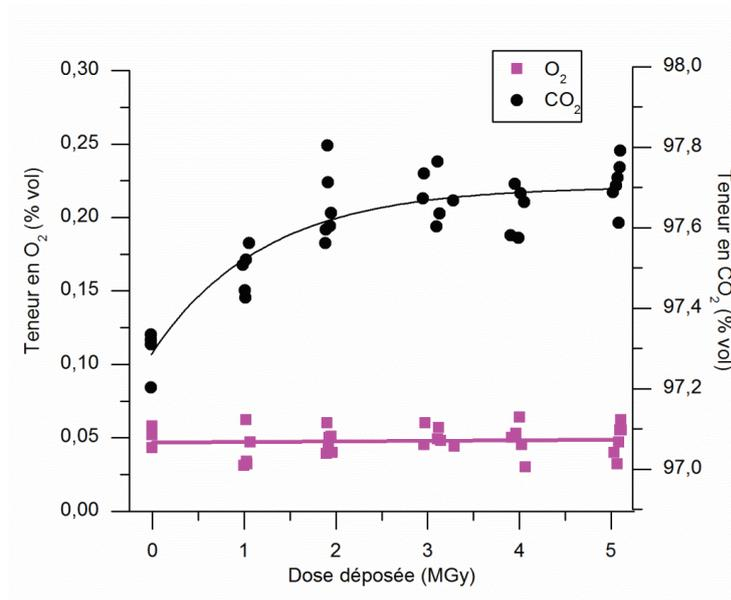
Figure 4 - 21 : Evolution de la concentration en  $CO_2$  et en  $O_2$  en fonction de la dose déposée.
