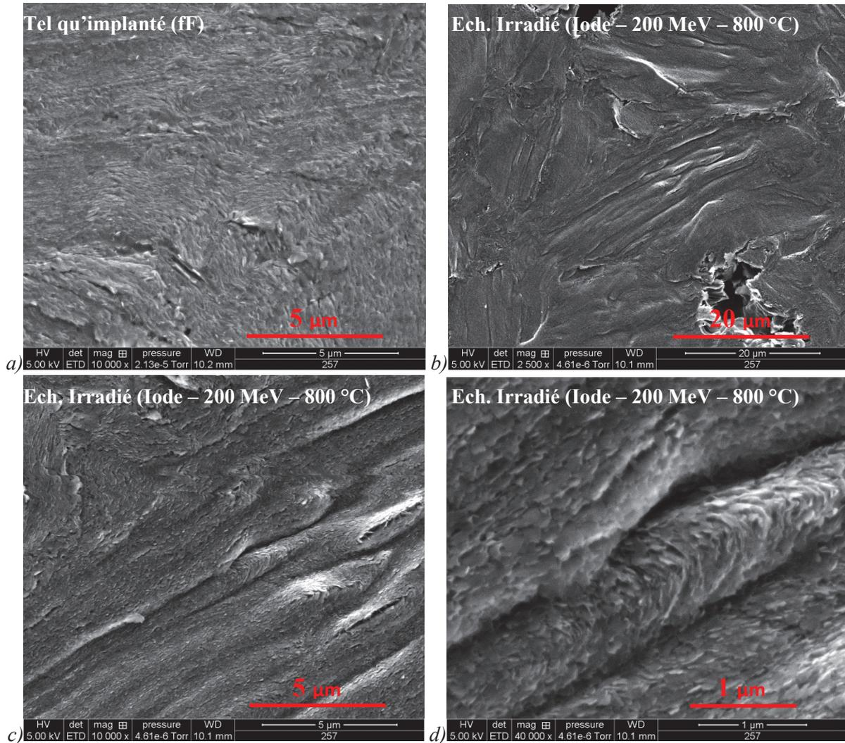
Figure 3 - 25 : Micrographies MEB (électrons secondaires) de la surface d'un échantillon tel qu'implanté (fF) et irradié à 800 °C avec un faisceau d'ions iode de 200 MeV. (a) tel qu'implanté (fF) x 10000, (b) irradié x 2500, (c) irradié x 10000, (d) irradié x 40000.
