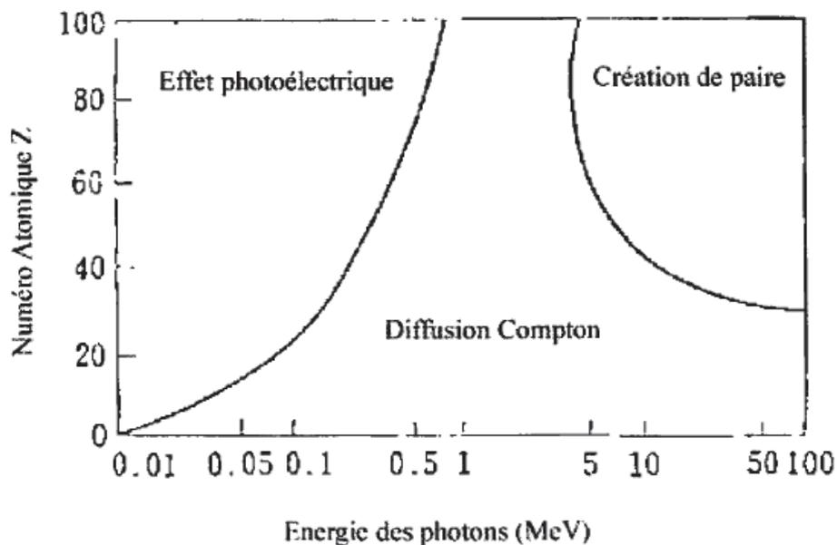
Figure 1 : Domaine de prépondérance des effets photoélectriques, Compton et création de paires en fonction de l'énergie du photon incident et de la masse atomique de l'absorbant [Wood 1980].
