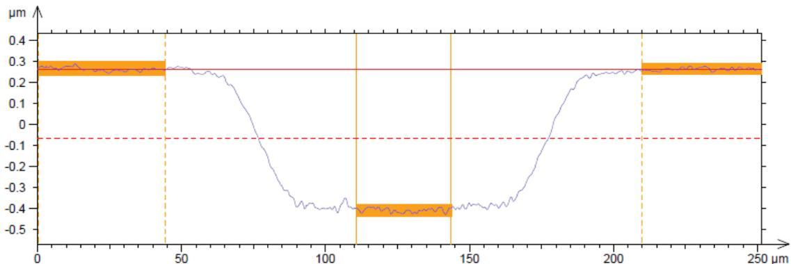
Figure 2 - 17 : Profil 2D moyen de la zone abrasée par l'analyse SIMS sur du graphite nucléaire.
