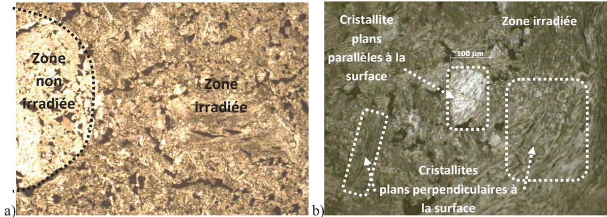
Figure 3 - 22 : Images de l'échantillon (FF) irradié à 1000 °C prises au microscope optique (a) x 5 et (b) x 20.
