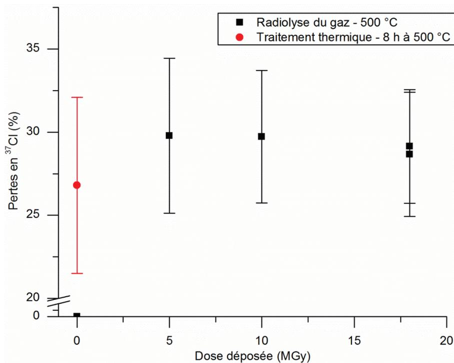
Figure 4 - 7 : Relâchement en chlore implanté en fonction de la dose déposée dans le gaz.
