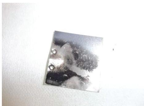
Figure 5 - 17 : Dépôt formé sur la feuille de nickel non irradié.
