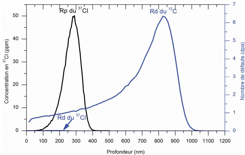
Figure 3 - 32: Simulation par SRIM 2010, des profils de concentration du chlore et de défauts induit par l'irradiation ( $^{12}\text{C}$  de 400 keV ;  $5 \times 10^{16}$  at.cm $^{-2}$ ) dans une matrice de carbone [Ziegler 1985].
