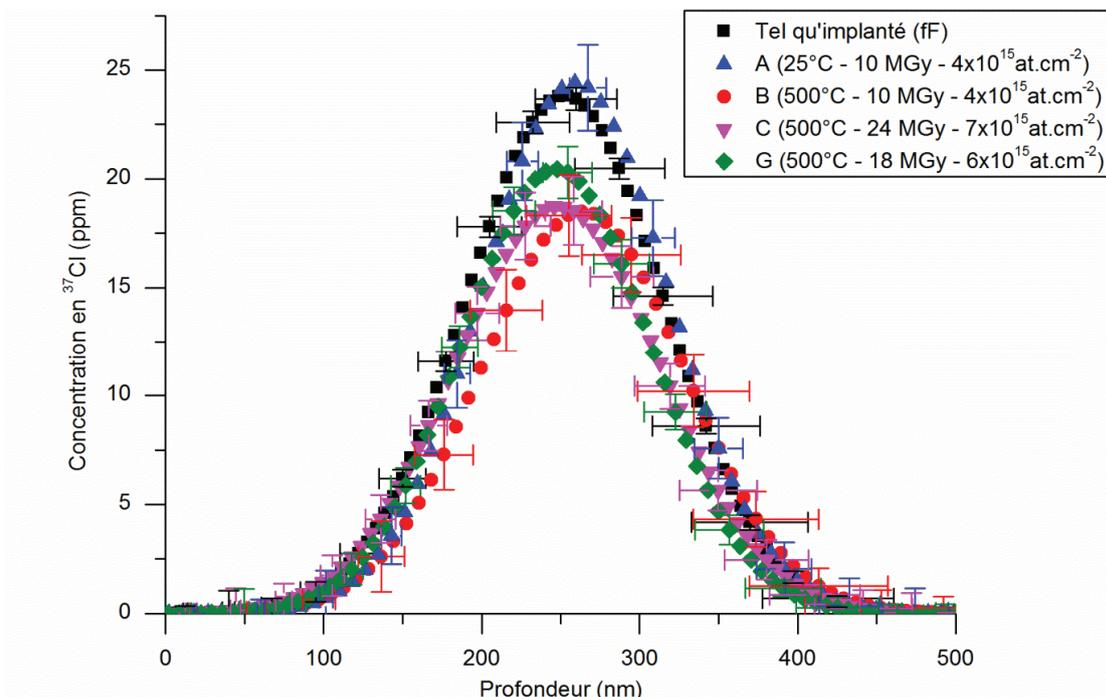
Figure 4 - 16 : Profils moyens de concentration en  $^{37}\text{Cl}$ , obtenus par TOF-SIMS, pour des échantillons de graphite nucléaire issus de l'empilement de Saint-Laurent A2 tel qu'implanté (fF), irradiés et mis en présence du gaz radiolysé.
