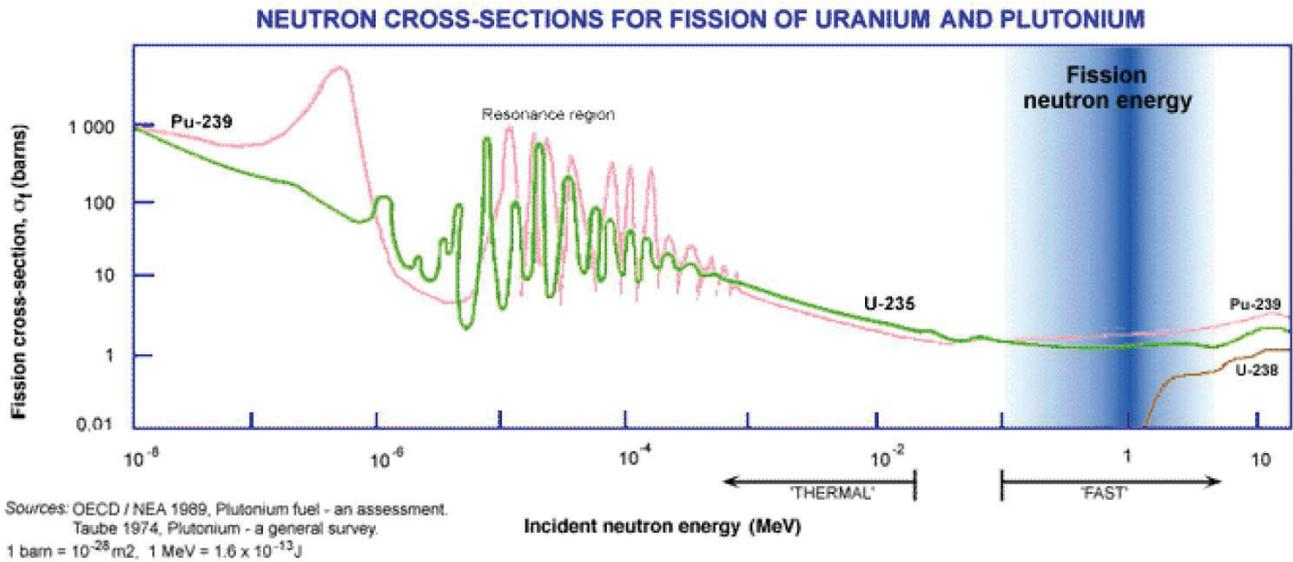
Figure 1 - 4 : Sections efficaces de fission induites par des neutrons sur l' $^{235}\text{U}$ , l' $^{238}\text{U}$  et le  $^{239}\text{Pu}$ .
