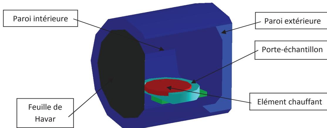
Figure 5 - 15 : Schéma de la cellule d'irradiation utilisée pour la synthèse des dépôts carboxyhydrogénés en configuration (1), c'est-à-dire, radiolyse seul du gaz en présence de l'échantillon non irradié.
