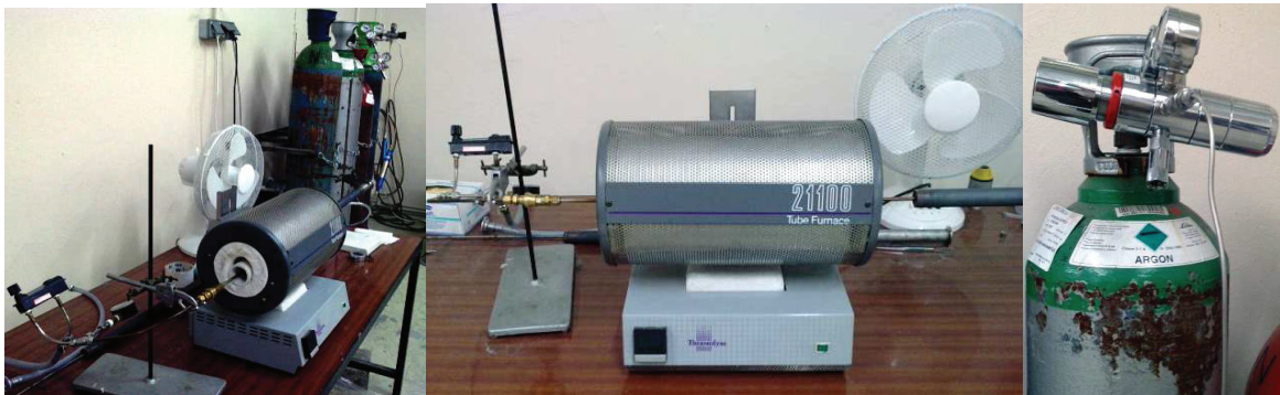
Figure 2 - 8 : Système de recuit à circulation d'argon (à gauche) comprenant le four tubulaire Thermolyne Furnace 21 100 (au milieu) et la bouteille d'argon B50 (à droite).
