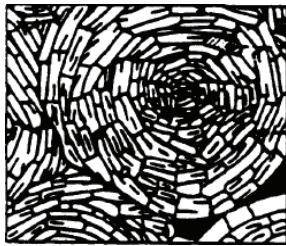
Figure 1 - 12 : Microstructures du coke isotrope [Cornuault 1981].
