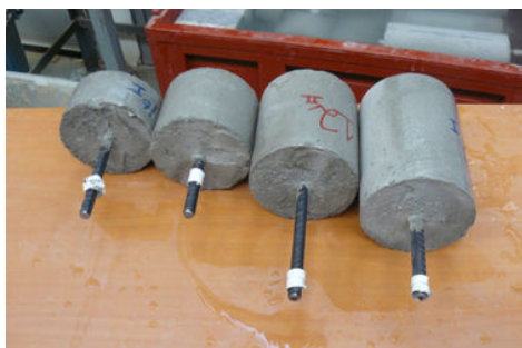
FIGURE 2.17: Étude d'une diminution de la longueur d'interface par diminution de la hauteur totale de béton
