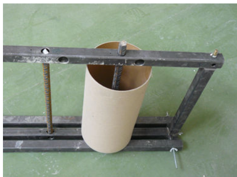
FIGURE 2.15: Exemple de mise en œuvre du banc de coulage
