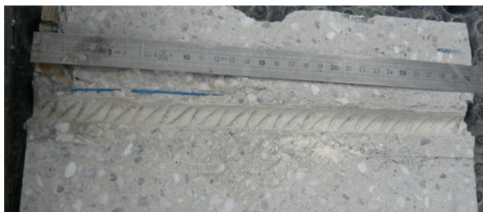
FIGURE 4.9: Faciès post-mortem de l'interface après sciage
