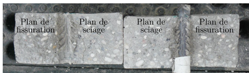
FIGURE 4.2: Observation du plan de fissuration après sciage de l'éprouvette de 70 mm de haut
