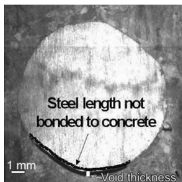
FIGURE 1.32: Vide créé sous une armature horizontale selon Söylev et François [2006]
