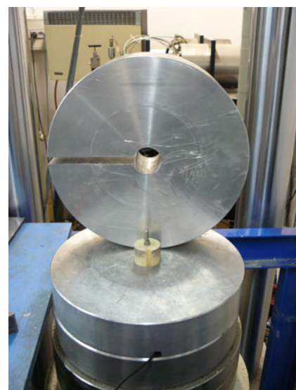
FIGURE 2.6: Capteur inférieur de déplacement LVDT et bague de support
