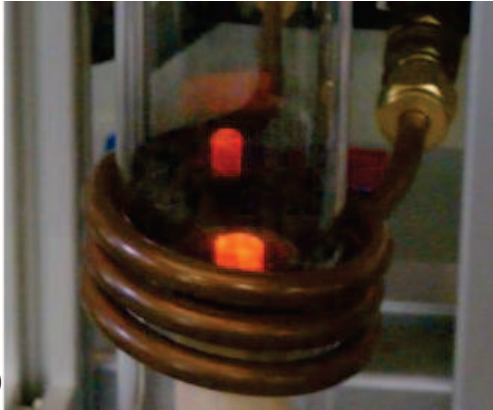
Figure D.I.6 : Bobines utilisées pour les expériences de frittage par induction : (a) 150 kHz et (b) 50 kHz.
