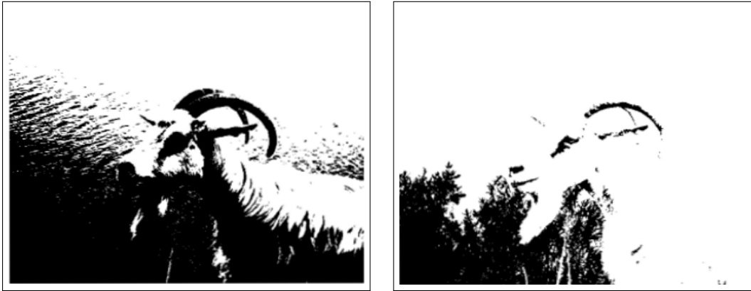
FIGURE 1.6 – Détection de régions par seuillage à 120 (à gauche) et seuillage à 180 (à droite).
