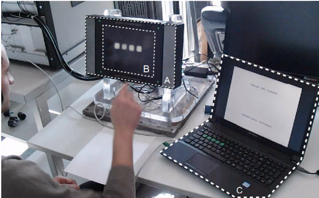
FIGURE 3.12 – Vue d'ensemble du dispositif expérimental employé dans l'expérience d'évaluation hédonique : A) Banc haptique ; B) Surface tactile à écran capacitif ; C) Système de communication PC-Appareil.
