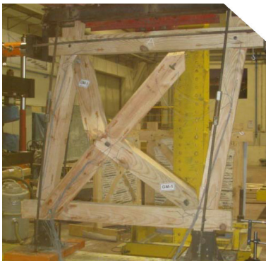
(a) SR1 : rupture hors-plan des contreventements
