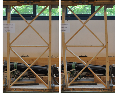
(b) Déformation du mur élémentaire sans remplissage à la fin de l'essai cyclique
