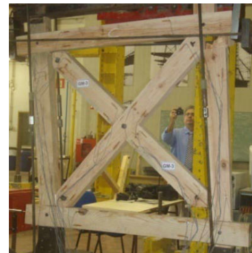
(c) SR3 : rupture du poteaux en traction dans l'assemblage mi-boit poteaux-lisse haute
