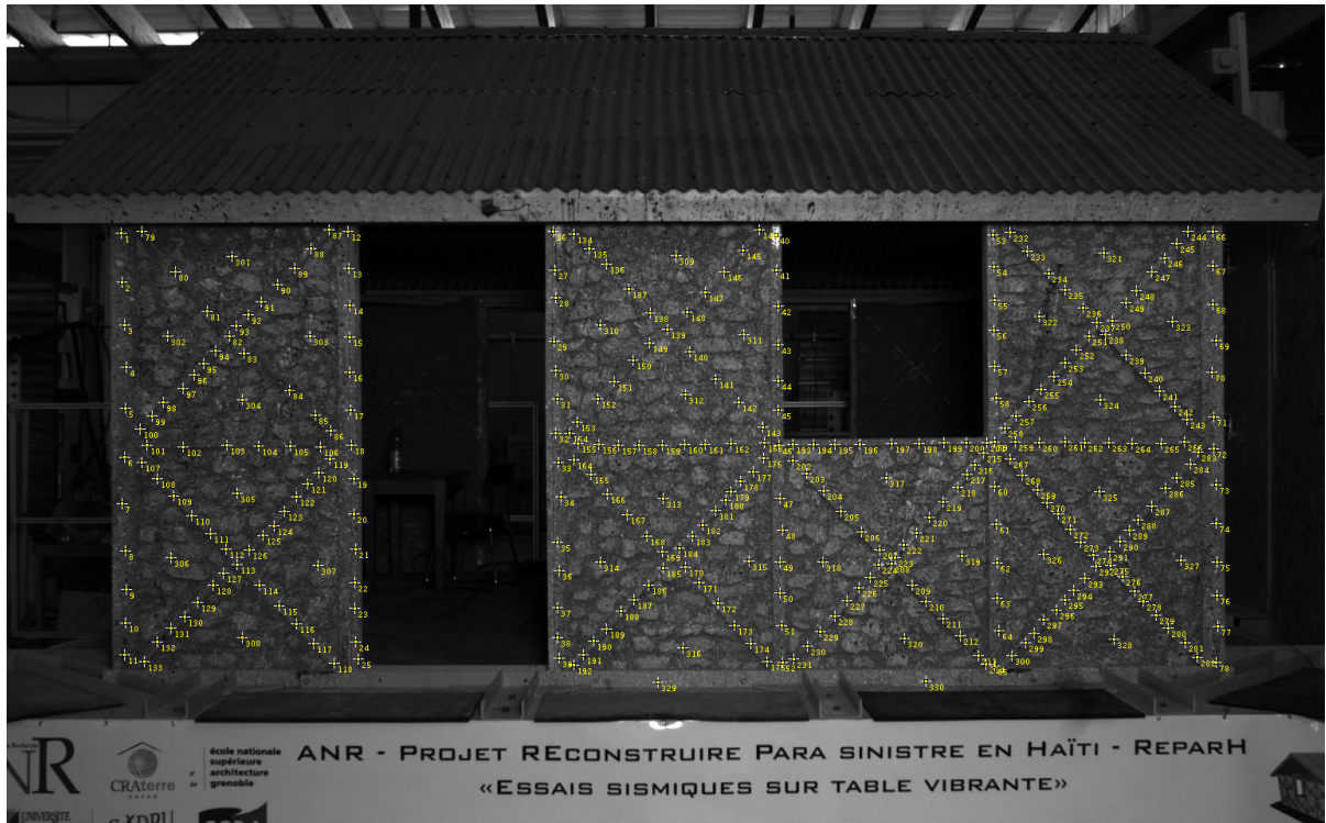
FIGURE 8.17 – Maillage du mur sous le logiciel Tracker
