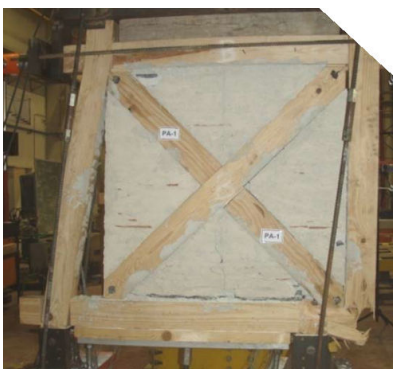
(d) R1 : rupture en cisaillement du bois dans l'assemblage mi-boit poteaux-lisse basse
