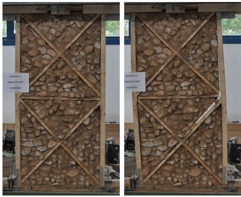
(a) Déformation du mur élémentaire avec remplissage à la fin de l'essai cyclique
