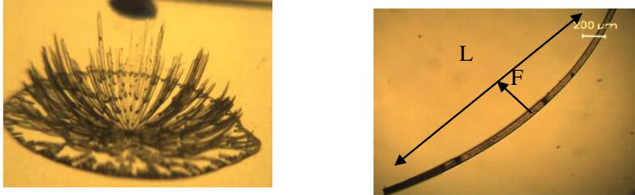
**Figure IV- 28 :** (a) Image de film fabriqué par séchage de goutte sessile de PBMA-R 10 % à 30°C montrant la délamination radiale et la courbure des fibres. ( b) profile de côté d'une fibre. La légende F et L sont les grandeurs qu'on a utilisées pour quantifier la courbure.
