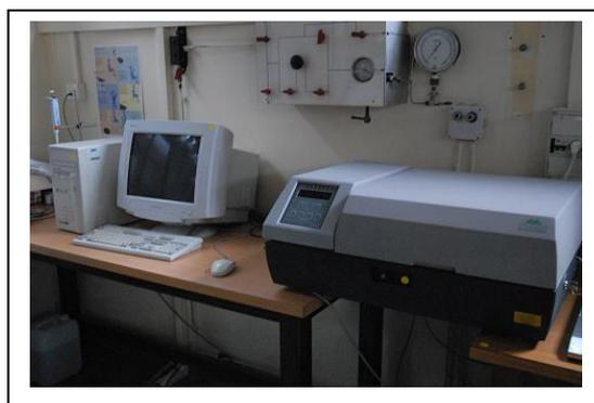
**Figure II 4 :** Dispositif de diffusion quasi-élastique de lumière.
