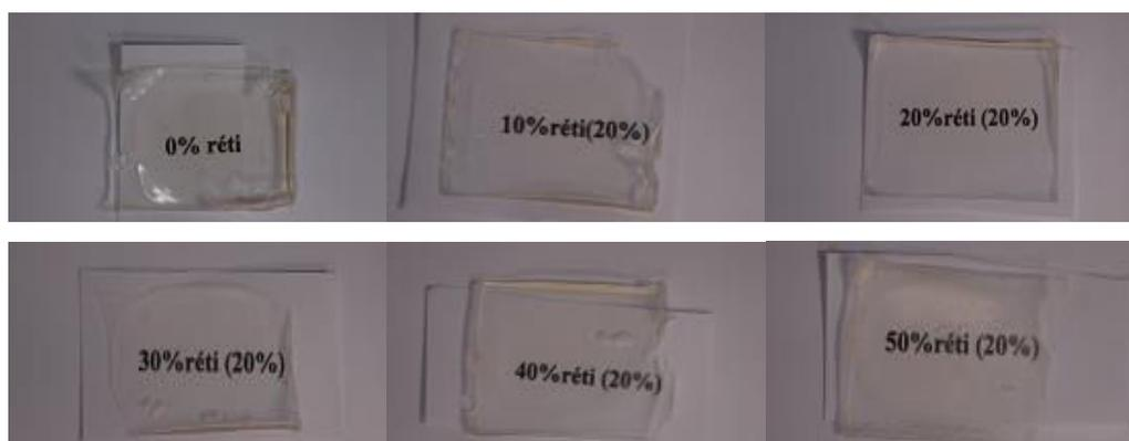
**Figure III- 3** : Image de films préparés par séchage de mélanges de suspensions PBMA et PBMA-R10% avec différentes fractions de particules réticulées PBMA-R20% de 0 à 0.5 Le films sont séchés à 60 °C. La légende au-dessus du film montre la fraction de PBMA-R20%.
