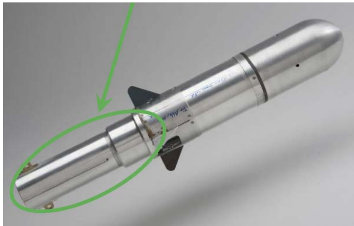
FIGURE 2.11 – Module parachute disposé à l'arrière du GLMAV
