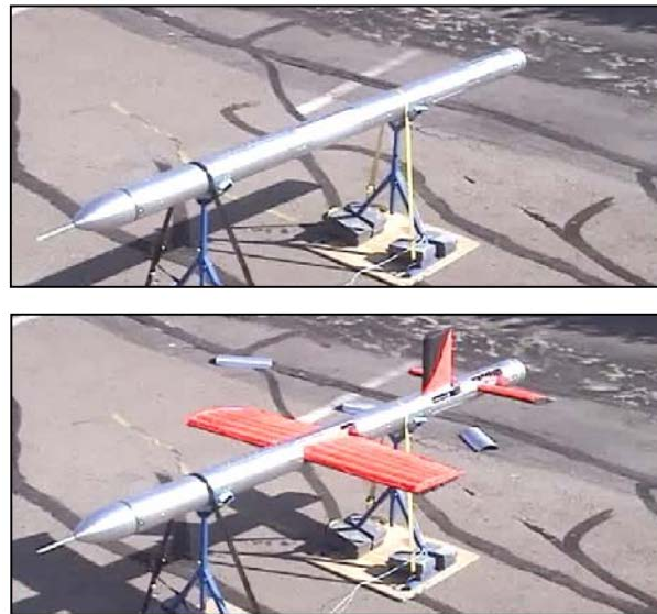
FIGURE 1.22 – Configurations non déployées et déployées du drone FASM/QuickLook UAV
