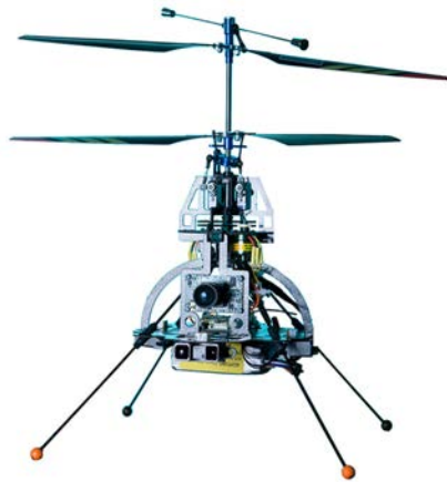
FIGURE 1.14 – Le drone hélicoptère à rotors coaxiaux CoaX de Skybotix AG
