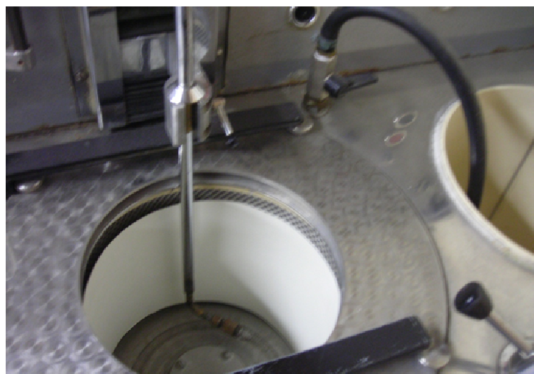
Figure 5.8: Vue du tambour de la formette dynamique et de la buse de projections de la suspension fibreuse.
