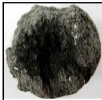
Figure II-32 : Image d'une boulette CVRD-DR, partiellement réduite, obtenue à partir d'un essai de réduction par H_2 , à 900°C, interrompu après 12 minutes de réaction (2 L/min de débit gazeux H_2/He 60/40 % vol.).
