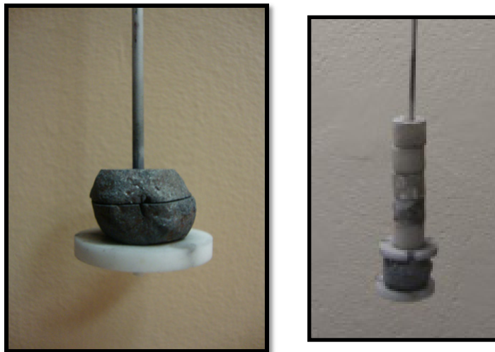
Figure III-5 : 2 ème dispositif expérimental pour mesurer les forces de collage : Boulette avec deux surfaces plates et parallèles, percée, coupée au milieu et posée sur le nouveau support en alumine (tige cylindrique avec un disque collé à l'une de ses extrémités) ( gauche ). Dispositif expérimental pour l'étude de l'influence de la compression sur la force de collage ( droite ).
