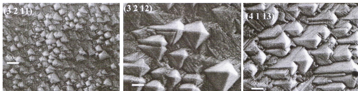
Figure I-25 : Images MEB des germes de fer sur une surface de wüstite réduite par \text{CO}/\text{CO}_2 (75/25 % vol.), à 800^\circ\text{C} . Germe sous forme de pyramides de bases carrées, avec différentes directions préférentielles de croissance [38].
