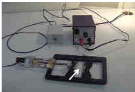
Figure 55. Dispositif d'étirement adapté sur un cadre platine de microscopie confocale.
