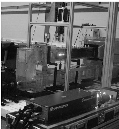
(a) Laser Quantronix Darwin-Duo et caméra Phantom V641
