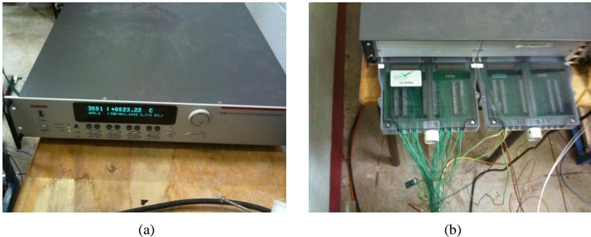
**Figure 2.11.** (a) Machine Keithley 3700 pour acquisition des données (b) connexion de la machine avec ordinateur
