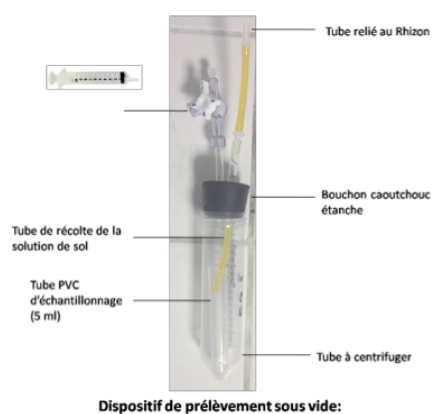
Figure 4.2 : Schéma photo du préleveur sous vide (P).
