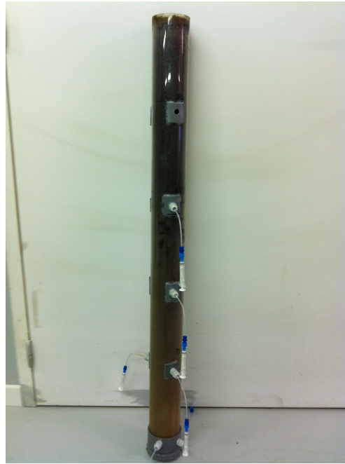
Figure 3.4 : Photo d'une colonne de laboratoire non saturée, appareillée par des Rhizons et seringues le long du profil.
