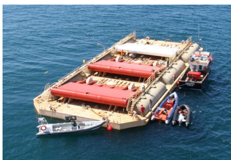
FIGURE 1.12 – Projet Surge : plateforme avec trois unités Waveroller à Peniche (Portugal), avant leur placement au fond
