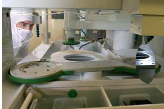
FIGURE 4.13 – Dispositif de polissage mécano-chimique du CEA Grenoble [45].
