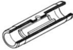
Figure 9 : Schéma d'un récipient de graphite pour SAA-FG (Perkin Elmer).
