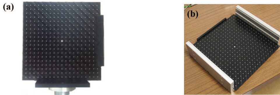
Figure 33 – Mire de calibration TSI avec rainures : (a) élément de centrage au bas de la mire pour la configuration 1 ; (b) élément de centrage à 3 hauteurs pour la configuration 2.
