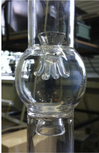
Figure III.7 : Photo du réacteur auto-agité en silice fondue
