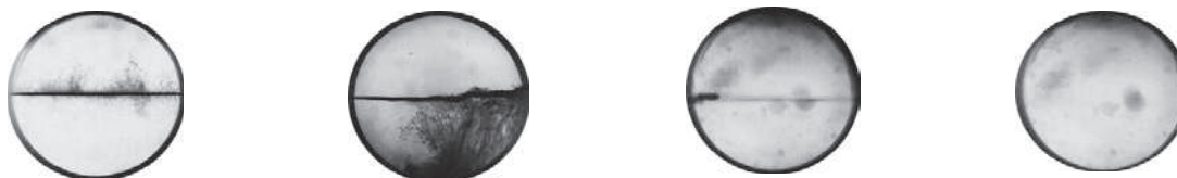
Figure 1.2 : Evolution de l'interface biphasique liquide/vapeur due à une augmentation des paramètres thermodynamiques (P, T) jusqu'au point critique ( http://www1.chem.leeds.ac.uk/People/CMR/criticalpics.html )
