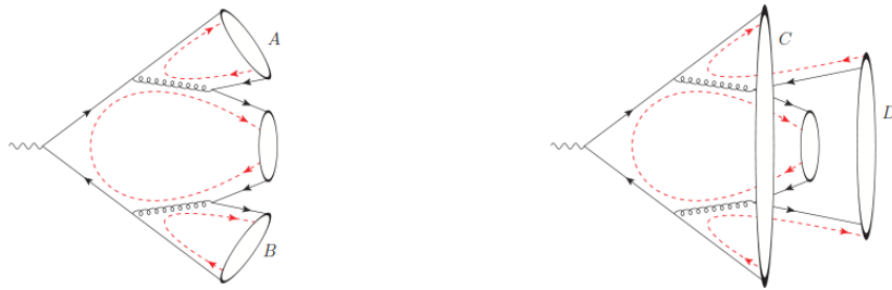
FIGURE 3.9: Hadronisation selon le modèle en amas, représenté par des ovoïdes. Les lignes de couleurs sont représentées en hachuré rouge. Les diagrammes de droite et de gauche illustre la façon dont la reconnexion de couleur peut influencer sur l'état final reconstruit.
