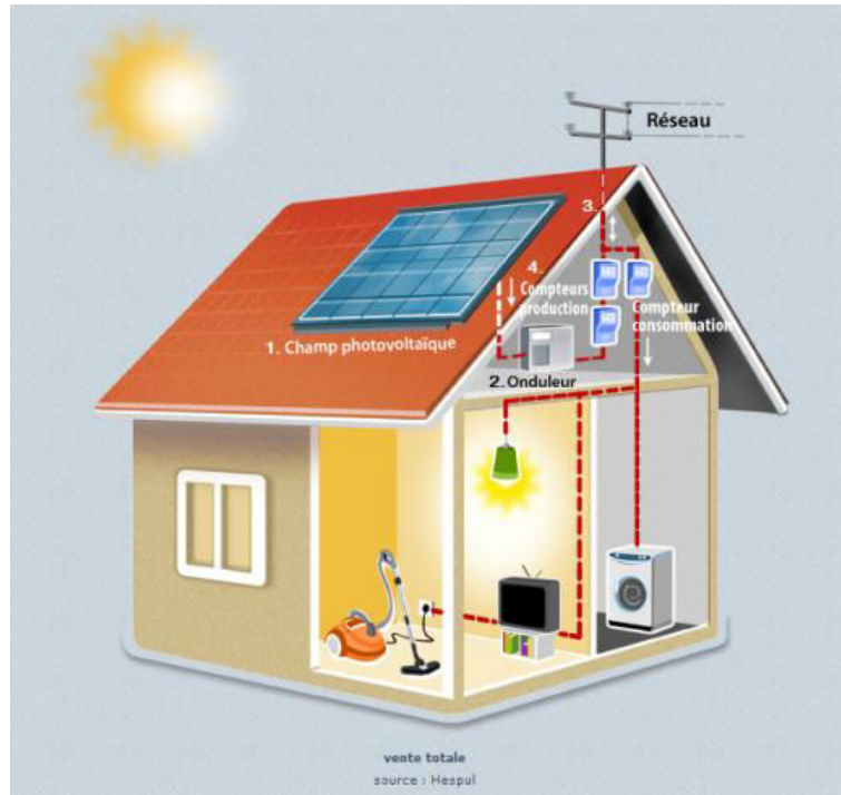
Fig. 1-10. Système photovoltaïque connecté au réseau [PRI-web]
