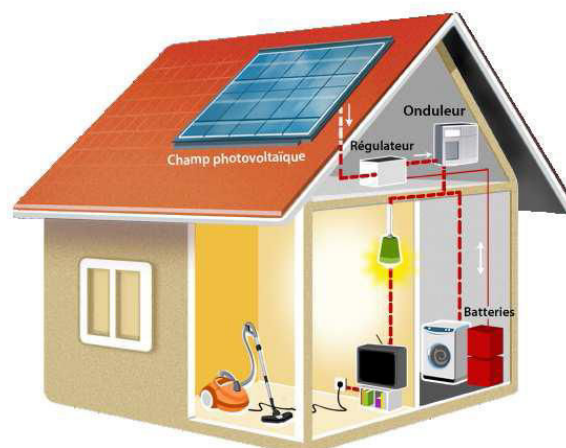
Fig. 1-7. Système photovoltaïque autonome [SYS-web1]
