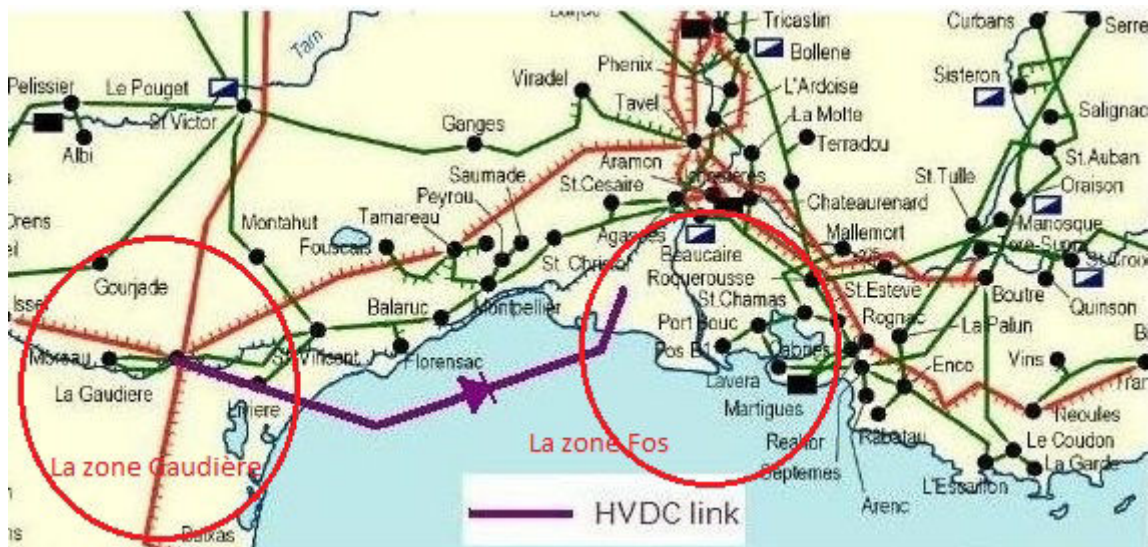
FIGURE 3.5 – Système électrique interconnecté Midi-Provence
