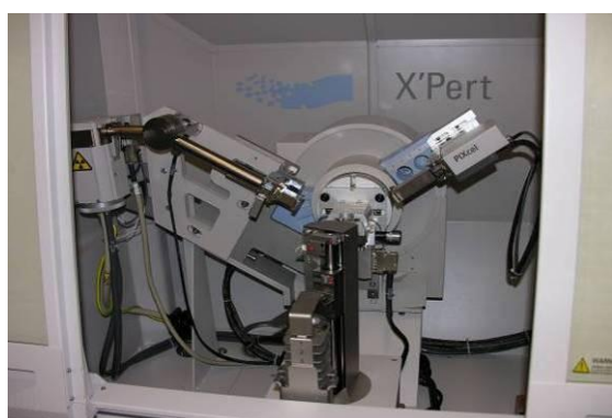
Figure B- 3: diffractomètre (à gauche), échantillons massif et broyé (à droite)
