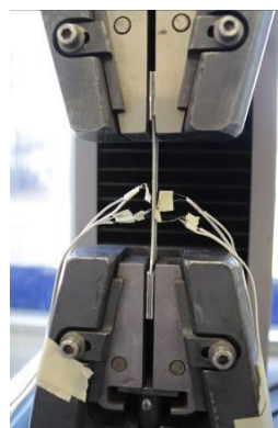
Figure B- 7 : instrumentation de l'essai de traction
