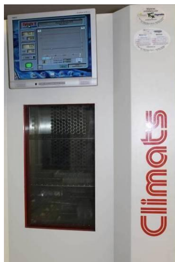
Figure B- 1 : enceinte climatique utilisée pour une condition de vieillissement accéléré
