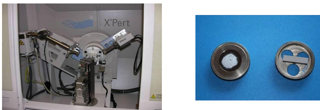
Figure B- 3: diffractomètre (à gauche), échantillons massif et broyé (à droite)
