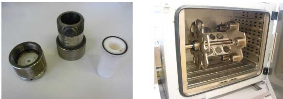
Fig.1: Photographies d'un autoclave en acier inoxydable Autoclave France et de sa chemise en PTFE (gauche) ainsi que d'une étuve munie d'un système d'agitation de type "tourne-broche" (droite)
