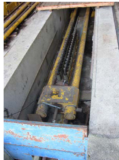
FIGURE 5.2 – a) Câble mis en tension ; b) Dispositif d'encastrement du câble
