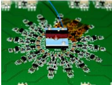
Figure 6. 2 : Electronique associée au détecteur barrette de 16 pixels à base de CdTe
