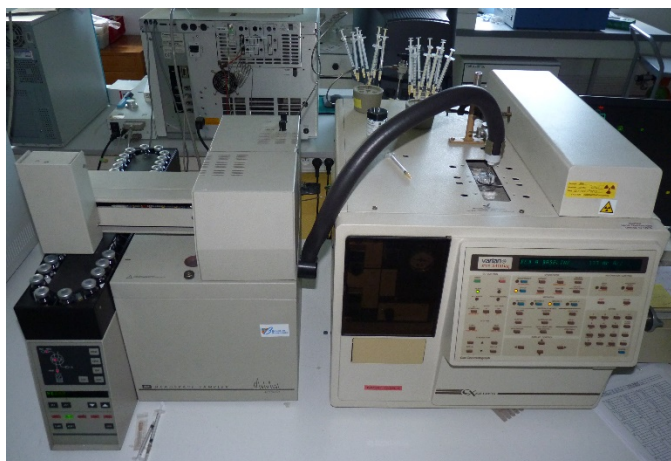
Figure II.9 : Varian® Star 3400CX couplé à un préleveur automatique.
