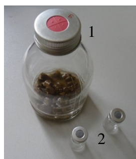
Figure II.10 : Exemple d'une fiole de 500 mL pendant l'incubation (1) et de fioles sous vide permettant le prélèvement des échantillons gazeux (2).
