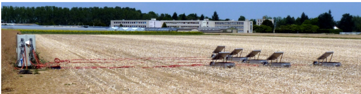
Figure II.6 : Disposition type des chambres de mesure à l'intérieur du système S1.
