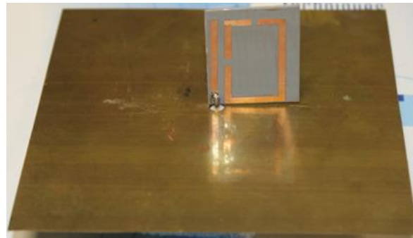
Figure IV.6 : Photo du prototype réalisé (Monopôle associé à un SRR intégrant deux circuits ouverts).
