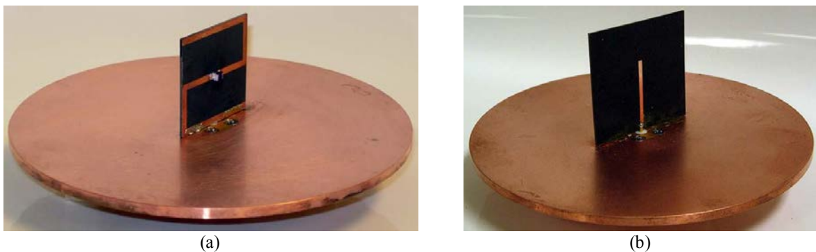
Figure I.12: Prototype de l'antenne Z (2D), (a): face du parasite Z, (b): face du monopôle.
