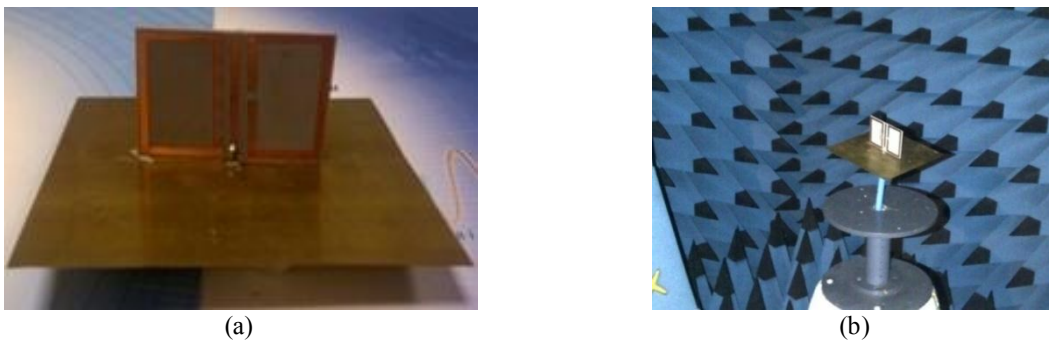
Figure IV.21 : Photos du prototype réalisé de l'antenne reconfigurable avec deux éléments SRRs.
