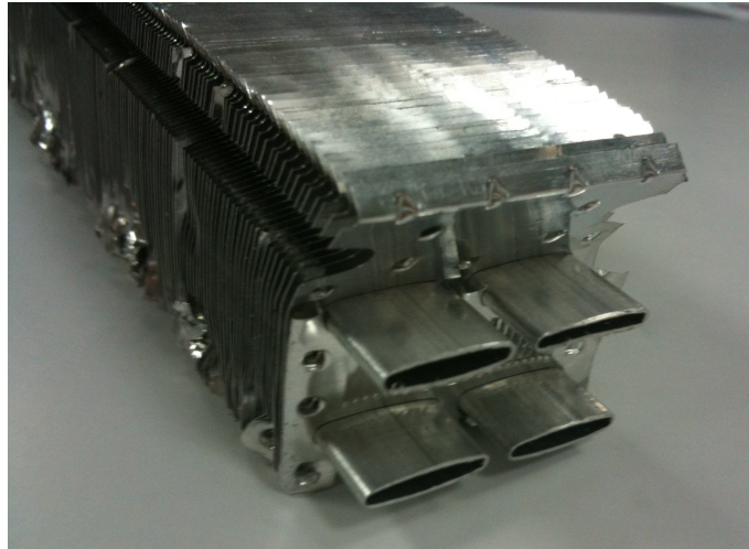
FIGURE 1.3: Photo d'un assemblage de tubes et d'intercalaires constituant un faisceau de radiateur mécanique
