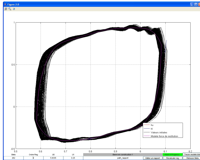
FIGURE 3.35: Exemple de cycle de forme parallélogramme - amortisseur à fluide magnéto-rhéologique
