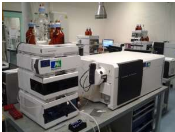
Figure 41 : Chaîne HPLC Infinity 1290 couplée au MS 6460
