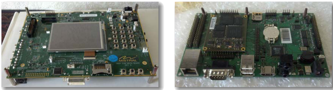
FIGURE 3.2 – Photographies des cartes Mistral Omap3evm (gauche) et Armadeus APF27 (droite) utilisées dans le cadre de ce travail de thèse.
