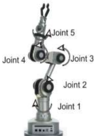
Figure 72. Bras robotique Katana 6M180 [extrait de documentation de société « Neuronics »].
