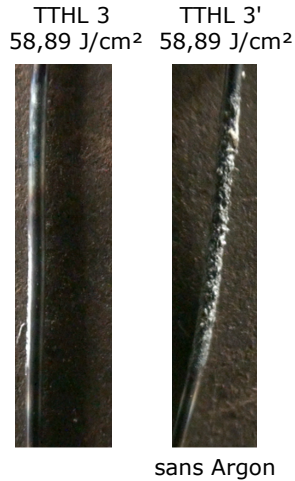
FIGURE B.10: Aspect des fils CW après les TTH Laser.
