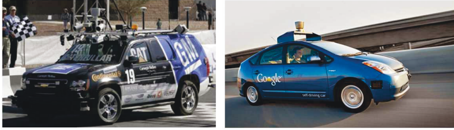
FIGURE 1.2 – Des exemples de voiture robotisées, où sur la gauche est le Boss (Urmson et al., 2008), vainqueur de la DARPA Urban Challenge, et sur la droite est la voiture de Google (Guizzo, 2011).
