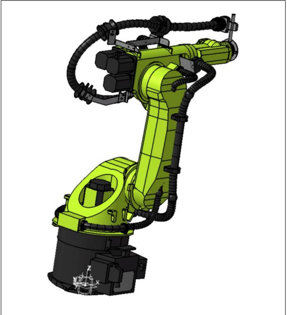
Figure 4.1 Bras de robot industriel modélisé sur la base de différents catalogues industriels<sup>17</sup>
