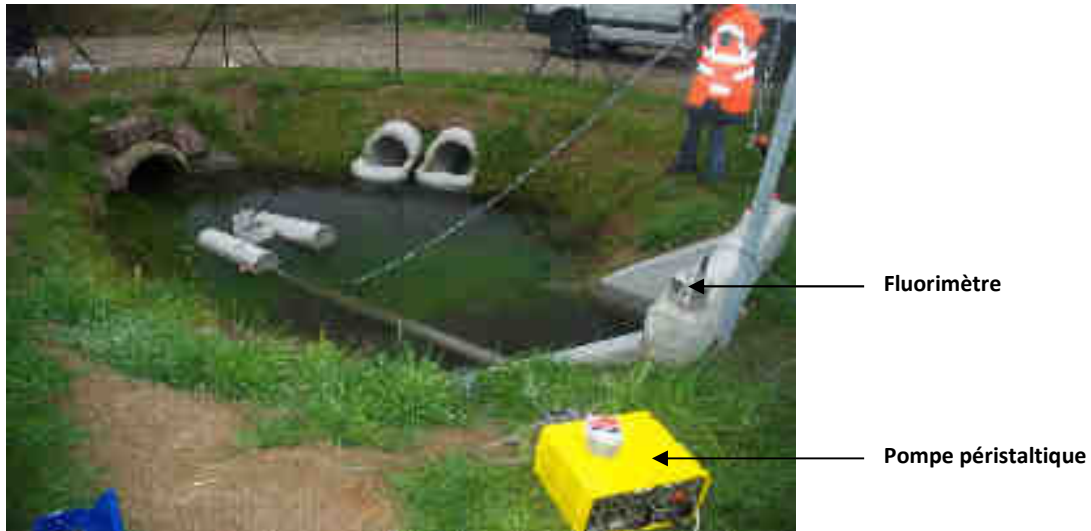
Figure 6-9. Dispositif de prélèvement à l'aide de la pompe péristaltique pour alimenter le fluorimètre (Photo Paul Bois)
