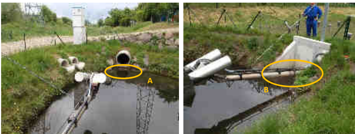
Figure 9-1. Points de prélèvement (en jaune) des sédiments des mares de sédimentation (exemple avec la mare n°1)
