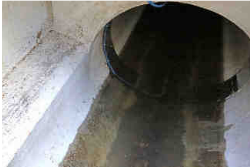
Figure B-1. Vélocimètre à effet Doppler dans le réseau d'assainissement du bassin versant n°3
