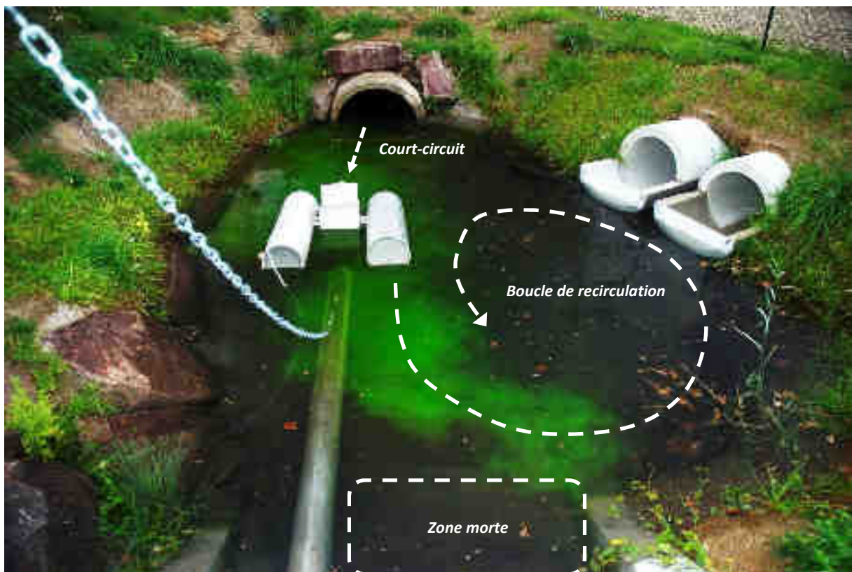
Figure 7-10. Observations visuelles lors du traçage hydrodynamique de la mare de sédimentation (photo Paul Bois)
