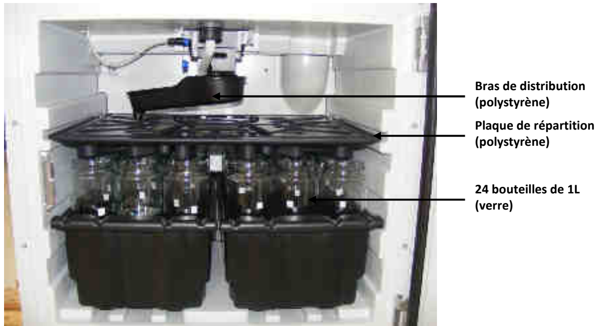
Figure 5-17. Description des matériaux internes au préleveur automatique (partie basse)
