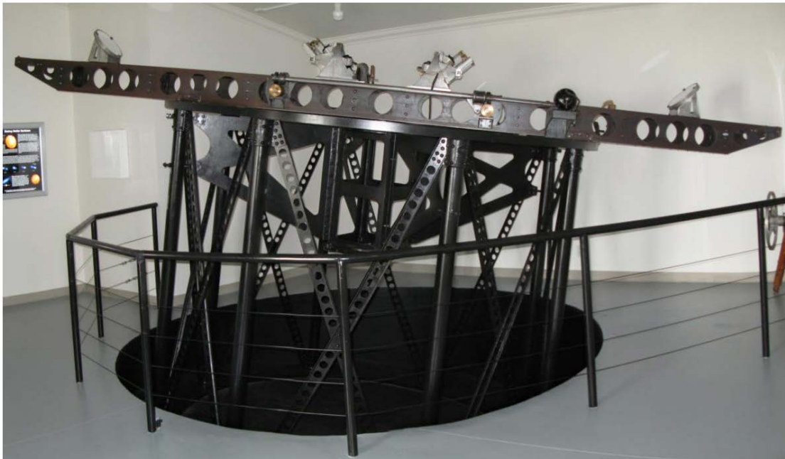
FIGURE 2.1 – L'interféromètre, constitué de 4 miroirs placés au sommet du télescope du Mont Wilson, ayant permis les premières déterminations de diamètres stellaires.
