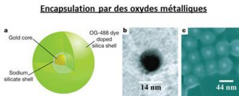
Figure 19 : a) Schéma représentant une particule hybride composée d'un cœur métallique (Au) enrobé de molécules fluorescentes (OG-488) dans une couche de silice. b) Cliché MET du cœur (Au). c) Clichés MEB des particules cœur-coquille Au/silice/OG-488. Source Noginov et al 79
