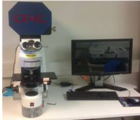
Figure 123 : Photographie du microscope équipé d'un spectromètre UV-visible-NIR « 20/20 PV™ UV-Visible-NIR Microspectrophotometer » permettant l'acquisition d'images et de spectres d'absorbance à la fois sur un échantillon.
