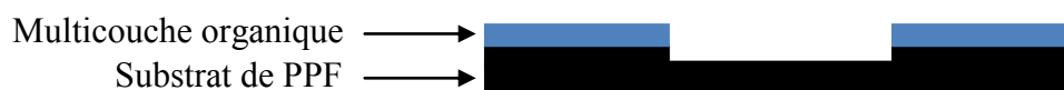
Figure A 5. Coupe transversale de l'échantillon après le grattage de la couche organique par AFM
